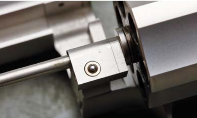
Die Trommelverriegelung erfolgt im Rückstoßschild/Stoßboden sowie mittels dieser federgelagerten Kugel im Trommelkran, die in eine korrespondierende Aussparung im Rahmen eingreift. (englisch „crane lock“).
