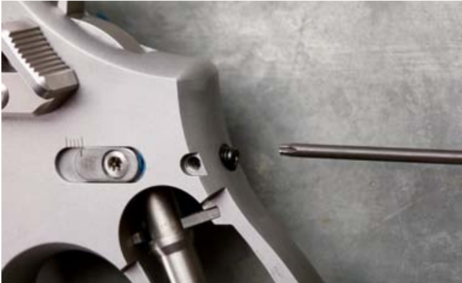
Die Rebound Spring (Rückstellfeder) lässt sich in ihrer Vorspannung von außen verändern. Darüber kann man im bestimmten Maße den Abzugswiderstand beeinflussen.
